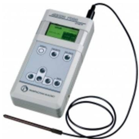
портативный рН-метр/нитратомер АНИОН-7000
