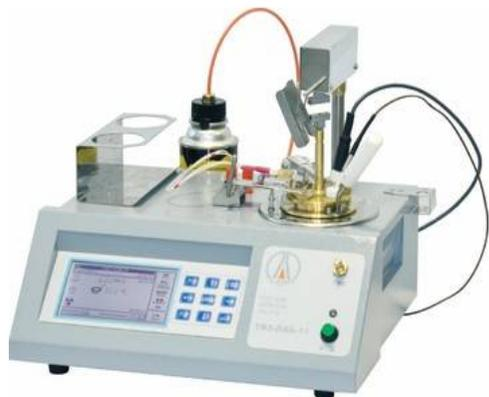
Автоматический аппарат ТВЗ-ЛАБ-11 предназначен для определения температуры вспышки в закрытом тигле по методу Пенски-Мартенса в соответствии с **ГОСТ Р ЕН ИСО 2719-2008, ГОСТ Р 54279-2010, ГОСТ ISO 2719-2013, ГОСТ 6356-75, ГОСТ 9287-59, ISO 2719, ASTM D 93 (методы А, В)**. Аппарат разработан с учетом всех требований нового ГОСТ Р ЕН ИСО 2719-2008 к проведению испытаний.
