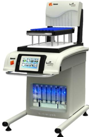
Автосэмплер Vision® G2 AutoPlus™ и коллектор Vision AutoFill™ представляет собой систему автоматического отбора проб. Система предназначена для реализации on-line анализа в нескольких вариантах: с возвратом образца в основные сосуды; сбором в виалы для дальнейшего офф-лайн исследования на ВЭЖХ-анализаторе или УФ-спектрофотометре; восполнением среды в основных сосудах.
