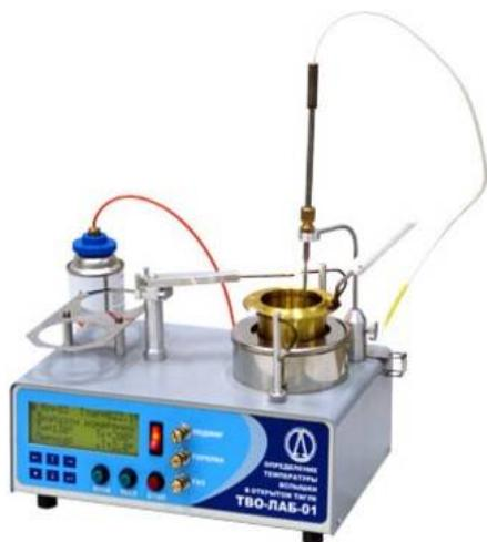
Полуавтоматический аппарат ТВО-ЛАБ-01 предназначен для определения температуры вспышки в открытом тигле по методу Кливленда в соответствии с ГОСТ 4333-87, ISO 2592, ASTM D 92.
