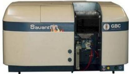
Применяются для быстрого и надежного анализа твердых и жидкых образцов на содержание в них различных металлов (большая часть периодической системы), а так же для контроля качества готовой продукции.
