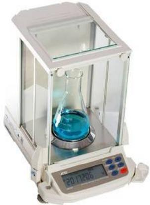
Весы аналитические серии GR со встроенной калибровочной гирей. Максимум производительности благодаря высокой скорости и простоте!
