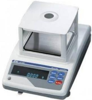
Весы лабораторные серии GX - классические прецизионные весы со встроенной калибровочной массой, работающие на технологии супергибридного сенсора.
