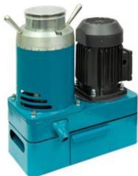
Вибрационная конусная мельница-дробилка (ВКМД) предназначена для дробления и измельчения твердых и хрупких сыпучих материалов различной прочности.
