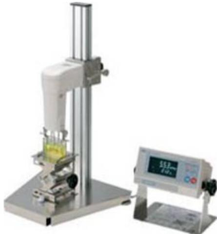
Компания A&D представляет инновационный метод измерения вязкости - вискозиметр, основанный на методе камертонной вибрации.
