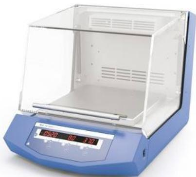
Встряхиватель-инкубатор KS 3000 предназначен для работы в термостатируемой среде без наблюдения оператора.
