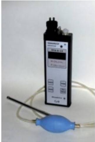
Газоанализатор инфракрасный ПГА предназначен для измерений объемной доли метана (CH<sub>4</sub>), пропана (C<sub>3</sub>H<sub>8</sub>), углекислого газа (CO<sub>2</sub>), кислорода (O<sub>2</sub>), водорода (H<sub>2</sub>) и массовой концентрации угарного газа (CO), сероводорода (H<sub>2</sub>S), сернистого газа (SO<sub>2</sub>), диоксида азота (NO<sub>2</sub>), аммиака (NH<sub>3</sub>) и суммы предельных углеводородов Σ(C<sub>2</sub>-C<sub>10</sub>).
