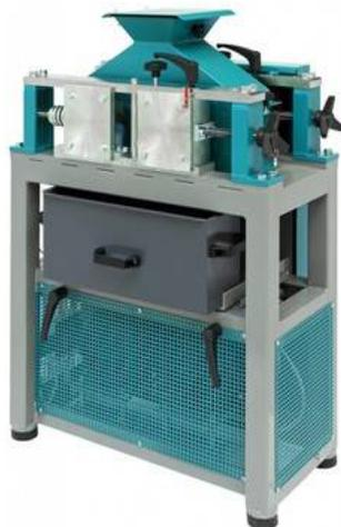
Валковая дробилка с гладкими валками предназначена для дробления хрупких материалов различной прочности.
