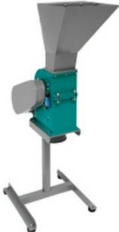
Дробилки молотковые лабораторные применяются при переработке отходов строительных материалов, глины, соли, кирпичной крошки, минералов, стекла, огнеупоров, шлаков, растительных материалов, отработанных формовочных смесей, отходов электроники и многих других материалов.
