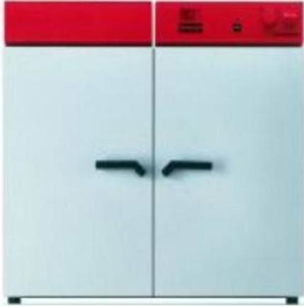
Серия BD специально разработана для проведения долгосрочных непрерывных работ по инкубации микроорганизмов, например, на агаровых пластинках, и кондиционированию чувствительных к нагреванию питательных сред.
