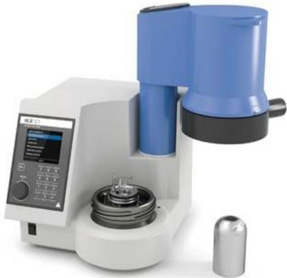
Калориметр С1 относится к последнему поколению калориметров сгорания со статической рубашкой, имеет высокую степень автоматизации и требует значительно меньше пространства по сравнению с обычными калориметрами.
