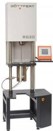
**Капиллярные реометры** предназначены для получения реологических кривых расплавов полимеров в области высоких давлений и скоростей сдвига – при нагрузках на поршень до 120 кН. Испытание на капиллярном реометре позволяет количественно предсказать в лабораторных условиях реологическое поведение полимера в условиях переработки (методом экструзии, инжекционного литья и т.п.). Методики в основном определяются (но не исчерпываются) стандартами ISO 11443 и ASTM D3835.
