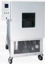
Регулировка и поддержание влажности в самом широком диапазоне. Применяются для контроля качества изделий и узлов в радиоэлектронной, упаковочной, фармацевтической промышленности, для проведения исследований при пониженных температурах до -70 °С (двухкаксадный холодильный агрегат), в диапазоне положительных температур до +100 °С (возможно сделать диапазон поддержания температуры и влажности более широким, подробности уточняйте у наших специалистов). Точность регулировки влажности: от 3 %.
