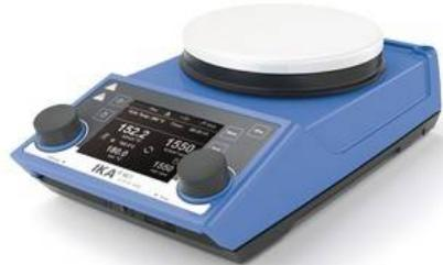
Безопасная магнитная мешалка с нагревом и встроенными весами.
