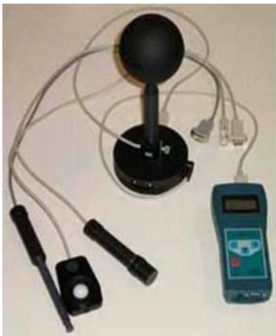
Метеометр МЭС-200 - прибор для контроля параметров воздушной среды, предназначен для измерений параметров воздуха рабочей зоны, микроклимата и аттестации рабочих мест на промышленных предприятиях, в общественных учреждениях, центрах и лабораториях санитарно-эпидемиологического надзора, экологического контроля и охраны труда. Метеометр может быть также использован для настройки и проверки качества работы вентиляционных систем.
