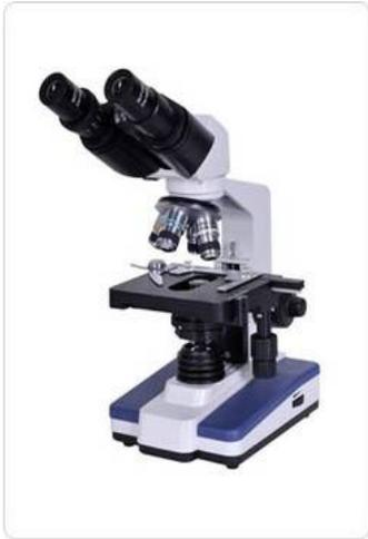
Недорогой, но в то же время качественный, микроскоп Альтами БИО 4 может быть использован для рутинных работ в биомедицинских и ветеринарных лабораториях, а также для учебных целей в школах и ВУЗах. Микроскоп обеспечивает исследования в проходящем свете методом светлого поля. Альтами БИО 4 может поставляться с бинокулярной или тринокулярной насадкой. Межзрачковое расстояние плавно регулируется в пределах от 55 до 75 мм, а подстройка диоптрийной разности - от -5 до +5 диоптрий.
