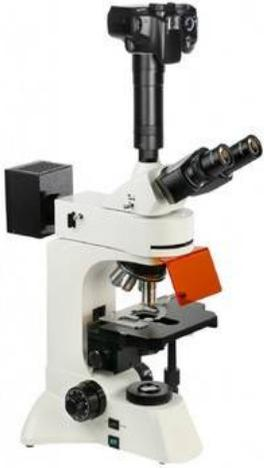
Данная модель похожа на микроскоп Альтами ЛЮМ 1, но в качестве источников отраженного и проходящего света используются светодиоды.
