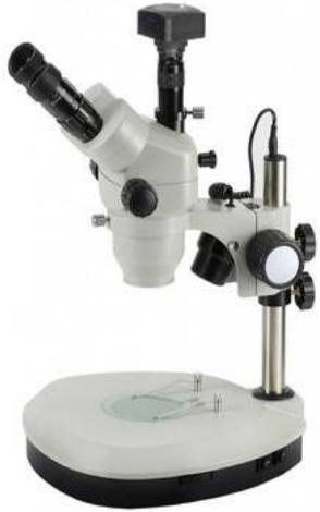
Цифровой вариант (снабжен камерой для вывода изображения на ПК) стереоскопического микроскопа Альтами SM0745. Увеличение от 7 до 45 крат (диапазон может быть расширен за счет дополнительной оптики), рабочее расстояние 118 мм (может быть увеличено до 275 мм). В комплекте предметный стол со встроенными светодиодными осветителями проходящего и косоугольного света. Сферы применения: микроэлектроника, пайка, ремонт, геология, зоология и ботаника, криминалистика, ювелирное дело.
