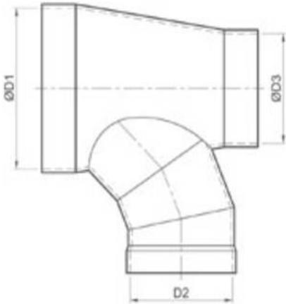
Конический патрубок с отводом для соединения трубопровода.
