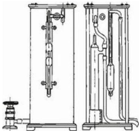
Предназначен для измерения удельной поверхности цементов. Может применяться для измерения удельной поверхности ряда других порошкообразных материалов (гипса, угольной пыли).
