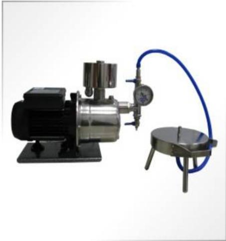
Прибор вакуумного фильтрования обеспечивает быстрое фильтрование пробы и слив отфильтрованной воды в канализацию. Изготавливается под мембранный фильтр Ø142 мм.
