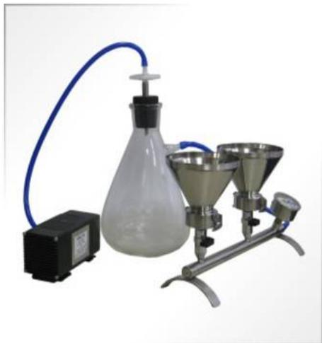
Прибор вакуумного фильтрования представляет собой закрытую фильтрационную систему. Отфильтрованная вода собирается в ресивере. Фильтр-влажнотделитель препятствует попаданию капель жидкости в камеру вакуумного насоса. Изготавливается с 1, 2, 3 или 4 воронками под фильтр Ø47 мм.
