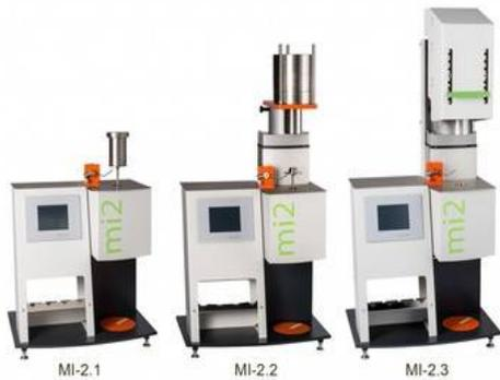
Автоматические пластометры серии mi2.x производства фирмы Göttfert (Германия) позволяют производить определение ПТР термопластов согласно стандартам ISO 1133, ASTM D1238 по процедурам А (ручная), В (автоматическая) и С (с «половинной фильерой»), а также ASTM D3364 (для ПВХ) и ГОСТ 11645-73. Приборы оснащены датчиком перемещения поршня и промышленной компьютерной системой с сенсорным экраном.
