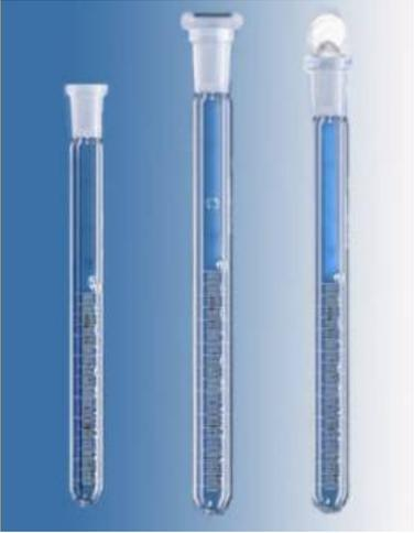
Пробирка исп.2 мерная со шлифом КШ
