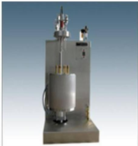
Рабочая камера реактора перемещается вверх/вниз относительно крышки с помощью пневматического лифта. Особенность модели заключается в том, что фланцы для подключения охлаждающей жидкости и система пневматического привода лифта расположены в задней стенке корпуса автоклава.
