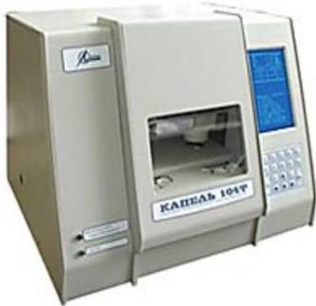
КАПЕЛЬ®-104Т - прибор высокоэффективного капиллярного электрофореза с УФ фотометрическим детектором. Источник света - ртутная лампа низкого давления с ВЧ возбуждением, обеспечивающая высокую стабильность светового потока. В качестве приемника применяется карбид - кремниевый фотодиод, чувствительный к области спектра 200-310 нм. Фотометр работает в условиях монохроматического режима. Этим обусловлены высокая чувствительность системы и широкий линейный диапазон определяемых концентраций.
