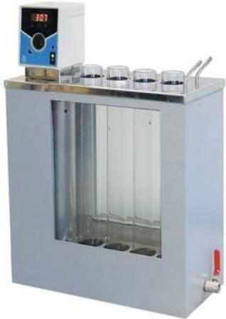
Термостат жидкостный LOIP LT-810 предназначен для термостатирования стеклянных цилиндров при определении плотности, в том числе при контроле качества нефтепродуктов по **ГОСТ Р ИСО 3675-2007, ГОСТ 3900-85, ГОСТ Р 51069-97.**
